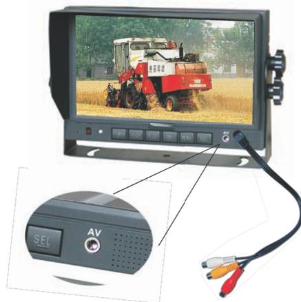
Schließen Sie das mitgelieferte AV (Audio/Video) Adapterkabel über den Klinkenstecker an den DVD/AV Eingang an der Frontseite der Monitor-Station an. Schließen Sie dann an die farbigen AV Buchsen, entsprechende ausgehende Stecker Ihres DVD/VCD Players an. Die Audio- und Videosignale werden danach an der Monitor-Station ausgegeben (Stellen Sie die den Monitor gegebenenfalls noch über die „SEL“ Taste auf den AV Kanal um).
